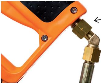
Le raccord coudé entre la lance RIPAGREEN® et le tuyau est tournant. Cette astuce permet de défaire d'un simple geste les boucles sur le tuyau. De plus, à l'intérieur, nous avons abandonné l'étanchéité avec un joint torique au profit d'une étanchéité avec une jonction sphéro-conique. Pas d'obsolescence programmée et une meilleure sécurité.
